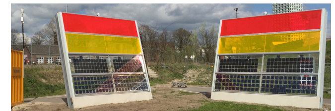
(Deels) transparante panelen: langs N470 nabij Pijnacker (boven) en proefopstelling Heijmans (onder) (Zonneweg A7)
